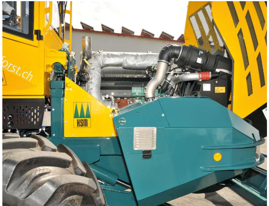
Oben: Es gibt bei HSM künftig die Volvo-Penta-Motoren in Vier- und Sechszylinder-Ausführungen mit jeweils Leistungen von 175 bis 210 PS (Vierzylinder) und 250 PS bis zu 320 PS (Sechszylinder). Geeignet sind die neuen Motoren für alle angebotenen Forstmaschinen, ob Harvester, Forwarder oder Skidder. Volvo Penta hat diese Motoren speziell für den Einsatz in mobilen Arbeitsmaschinen entwickelt. Fotos (2): Biernath
